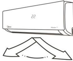
تأكد من انتظام توزيع الهواء في المكان المراد تكييفه عن طريق اختيارك الصحيح لحركة موجّهات الهواء المكيف حسب نظام التشغيل.
